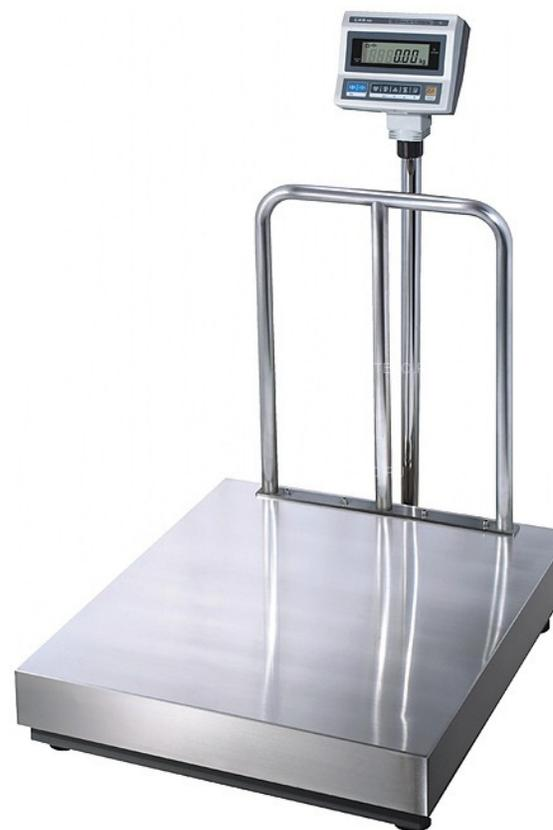
Напольные весы **\*\*CAS DBII-600\*\*** используются на предприятиях общественного питания и торговли. Модель оснащена жидкокристаллическим дисплеем с поворотной головкой на стойке, тензометрическим типом измерения, выражением массы в количестве изделий (счетный режим), усреднением показаний массы при нестабильной нагрузке и индикацией разрядки батареи.
