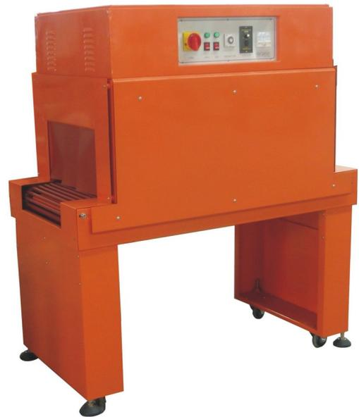
Термоусадочный тоннель BS-4535 - это производительный аппарат напольного исполнения для термоусадки полимерной пленки PP, PE, POE и других. В термоусадочную камеру предварительно упакованные в пленку продукты поступают по конвейеру. В ней происходит быстрый разогрев и усадка пленки.
